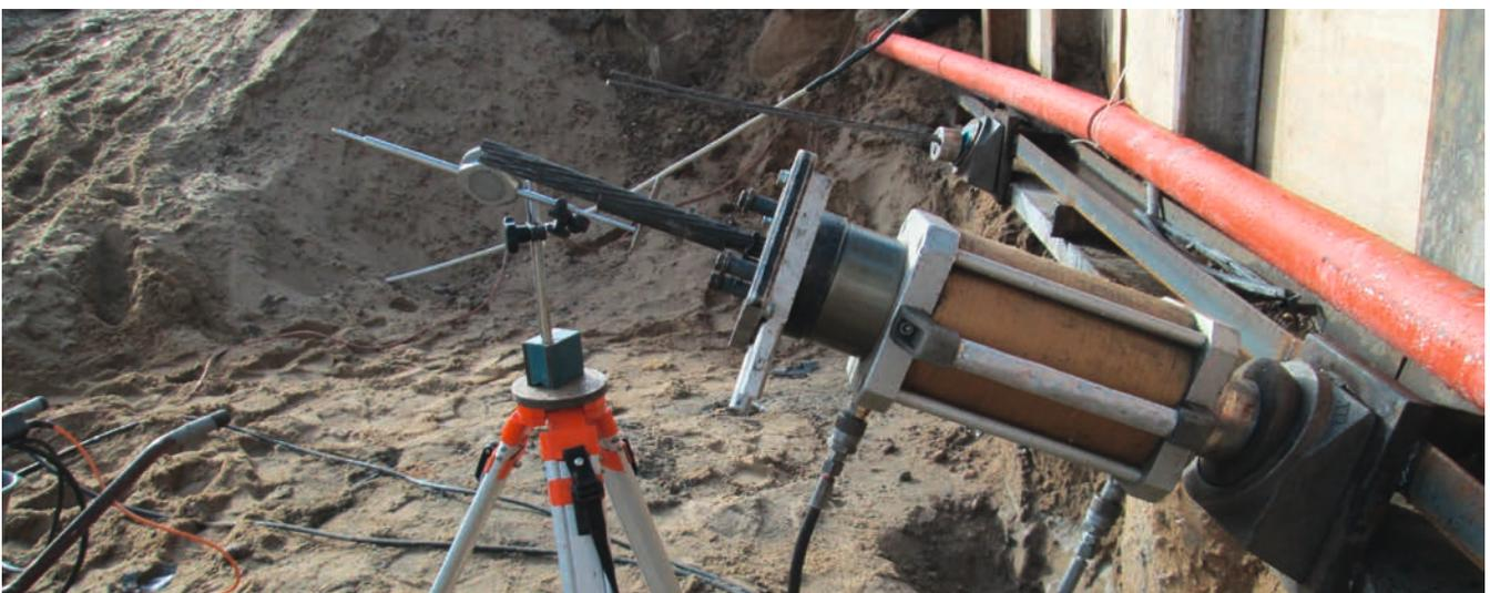
Bild 1: Zugprüfung eines Litzenankers
